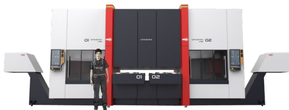
Bild2: Ebenfalls erhältlich, die UNIVERTOR V400 als Doppelspindler. Flexible Einsatzmöglichkeiten bei kompakten Maschinen-Außenmaßen
