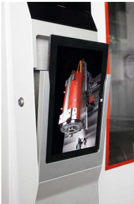
2 VR-Desk: Über ein Tablet-PC lassen sich via Virtual Reality alle benötigten Informationen rund um den erforderlichen Eingriff in die Maschine abrufen
