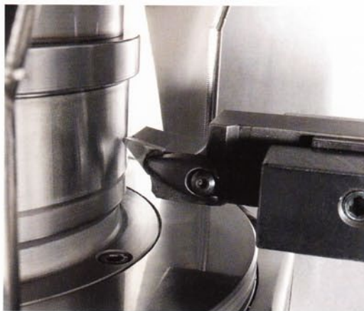
...und hier das Fenster für die Zerspanwerkzeuge für die Außen-Bearbeitung – für die Innen-Bearbeitung ist der Grundkörper des Stermanspannsystems unten offen.
