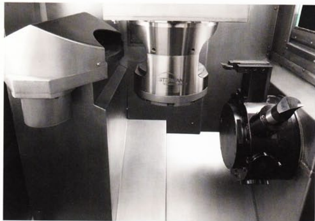
Alle relevanten spangebenden Technologien lassen sich einsetzen: etwa von links CBN-Schleifen oder von rechts außen Rotations-Drehen...
