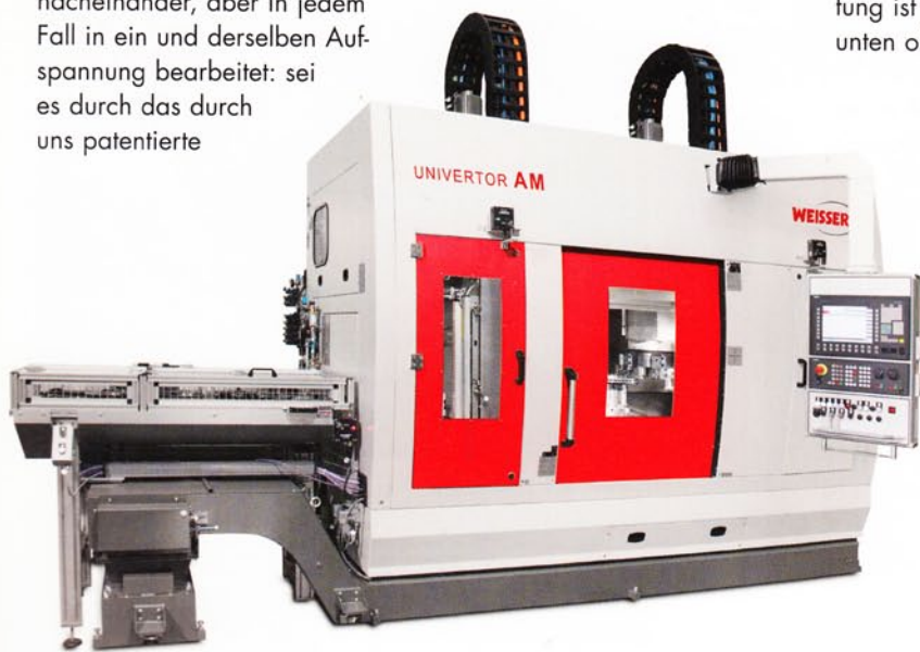
Auf solcher ‚Univertor AM‘-Drehmaschine mit integriertem Teile-Handlingsystem zeigte Weisser Söhne zur Metav die Außen- und Innen-Bearbeitung ringförmiger Werkstücke in einer Aufspannung mittels des innovativen Konsol-Spannsystems von Sterman.
